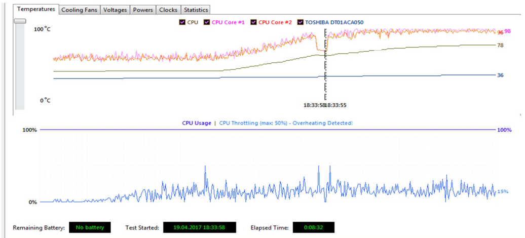
Рис. 2. Повышение температуры ЦП и активная работа функции Thermal Monitor1
