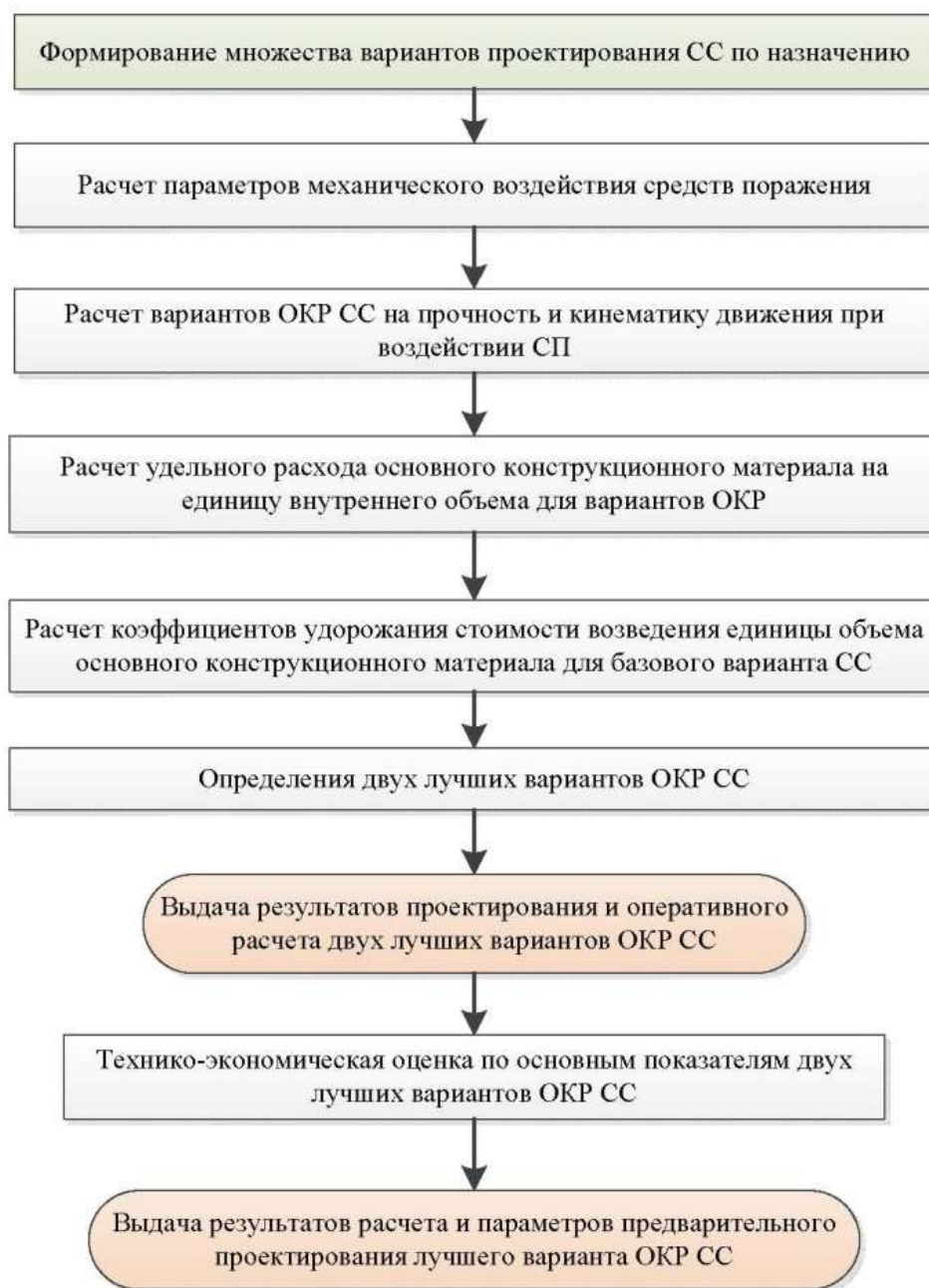
Рис. 2. Блок схема алгоритма определения оптимального объемно-конструктивного решения специального сооружения на этапе предварительного проектирования
