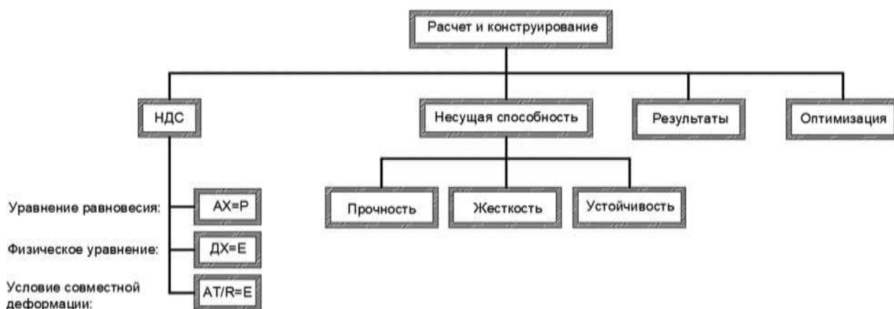
Рис. 2. Укрупненная блок-схема по расчету структурных плит средствами САПР
