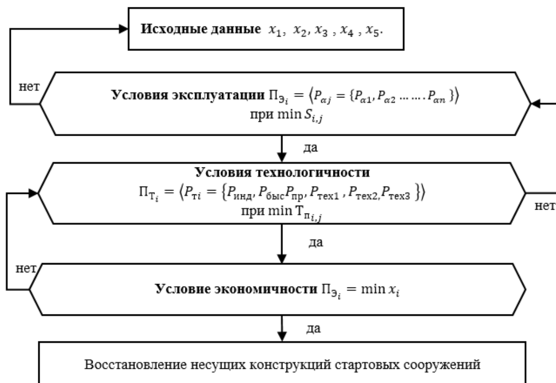
Рис. 6. Метод восстановления эксплуатационной пригодности несущих конструкций СС
