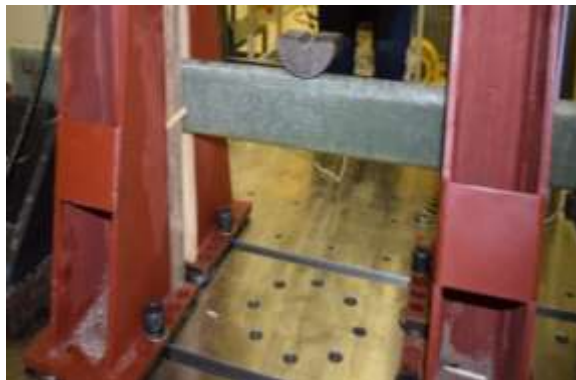
Рис. 2. Мелкомасштабная модель балки из стеклопластика
