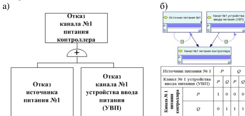
Рис. 2. Модель канала №1 питания контроллера: а – дерево отказов канала №1 питания контроллера; б – эквивалентная байесовская сеть
